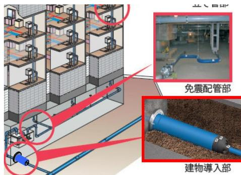
図 3 免震配管部、建物導入部
